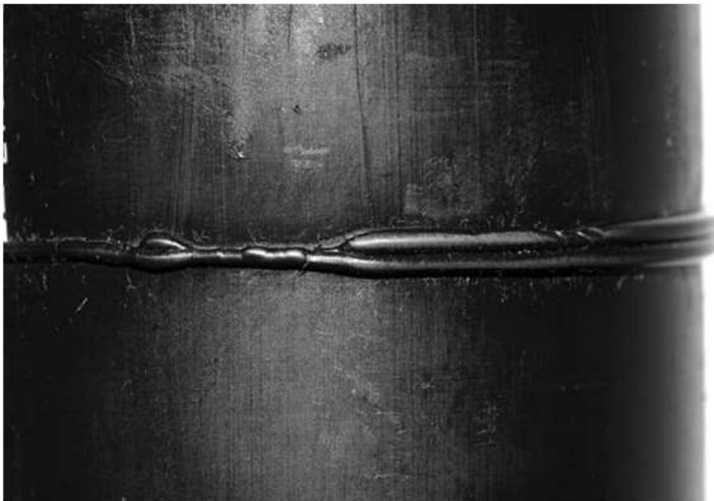
شکل ۱۳- وضعیت ظاهری غیرقابل پذیرش جوش لب‌به‌لب
