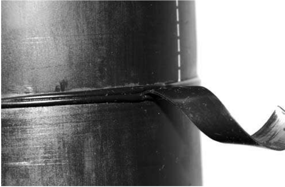
شکل ۱۳- وضعیت ظاهری غیرقابل پذیرش جوش لب‌به‌لب
